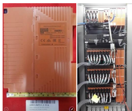
รูปที่ 3-81 Logic Solver ชุดสำรอง
